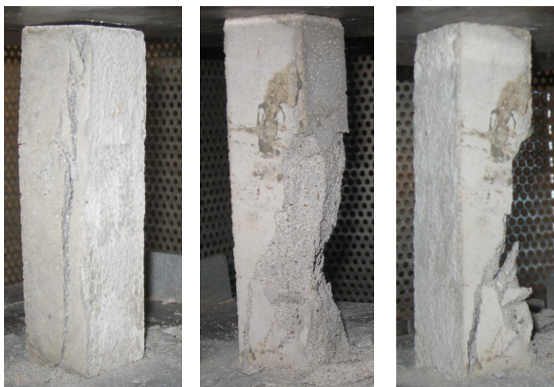
Рис. 6. Начало раздробления бетонных призм при достижении максимального усилия на прессе
