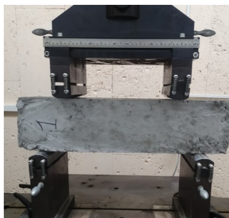
Рис. 4. Проведение экспериментальной части с использованием пресса Toni Technik 2078
